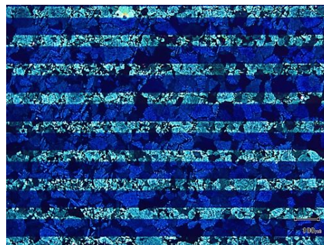
Figura 4. Fotografía obtenida por microscopía óptica de una película típica del material compuesto DB-TTF y PS10k en una relación 1:3 el ángulo entre el polarizador y el analizador es de 90°
